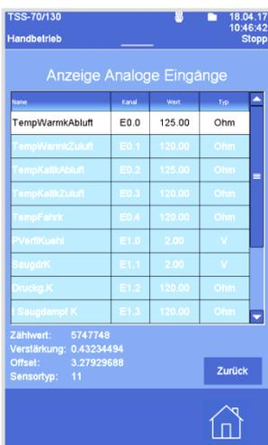
Die analogen Eingangskanäle werden mit Name, Kanalnummer, normiertem Wert und Typ angegeben.
