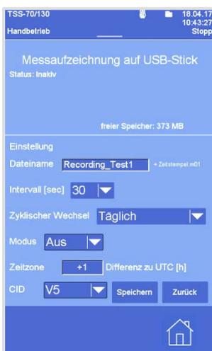
7. In dem Eingabefeld bei **Zeitzone** muss die aktuelle Zeitdifferenz zu UTC eingegeben werden. Damit wird gewährleistet, dass die Messaufzeichnungen (z.B. bei der Auswertung im CID-Programm) immer der aktuellen Zeit entsprechen.
