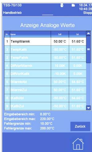
Die analogen Kanäle werden mit Name, Sollwert, Istwert und der Einheit angegeben.
