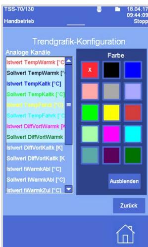
1. Die Kurve, die in der Trendgrafik angezeigt werden soll, in der Spalte **Analoge Kanäle** antippen
