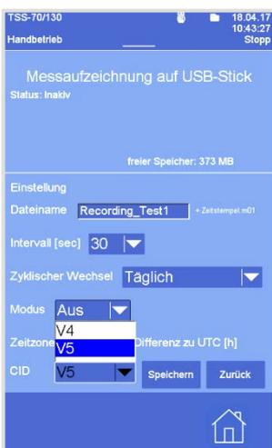
8. In dem Feld **CID** in der ▼-Liste auswählen, welche CID-Version zur Auswertung der Messaufzeichnung verwendet wird. Damit wird gewährleistet, dass die Messaufzeichnungen bei der Auswertung im CID-Programm optimal dargestellt werden.
