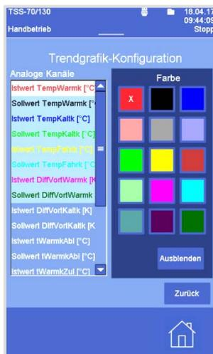
1. Die Kurve, die in der Trendgrafik **nicht** angezeigt werden soll, in der Spalte **Analoge Kanäle** antippen
