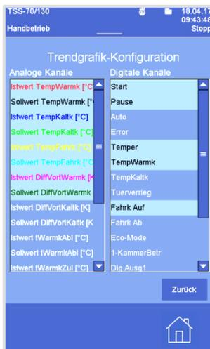
1. Die Kanäle, die in der Trendgrafik angezeigt werden sollen, in der Spalte **Digitale Kanäle** antippen
