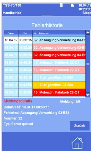
Mithilfe der seitlichen Bildlaufleiste kann durch die Fehlerhistorie geblättert werden. Sobald auf eine Meldung getippt wird, erscheinen unter der Fehlerhistorie die Meldungsdetails zu der angewählten Meldung:
