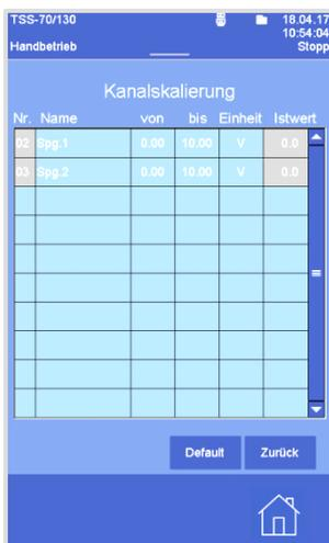
Dazu muss der gewünschte Kanal in der entsprechenden Spalte angetippt werden. Über den Ziffernblock bzw. die Tastatur können die Einstellungen festgelegt werden. Sobald die Taste **Enter** angetippt wird, werden die Einstellungen gespeichert.
