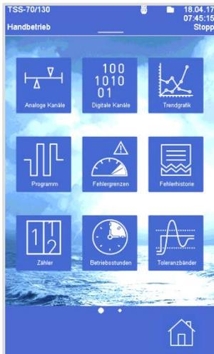
Über den Home-Bildschirm, ist der Zugriff auf alle Funktionen des Geräts möglich. Der Home-Bildschirm verfügt über mehrere Funktionsmenüs.
