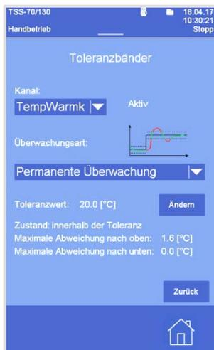
Im Menü **Toleranzbänder** können die erlaubten Abweichungen eines analogen Kanals im Manualbetrieb festgelegt werden.
