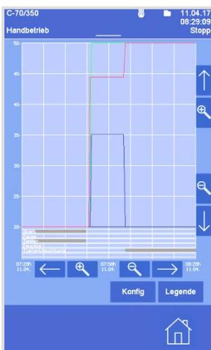
Der dargestellte Bereich der Trendgrafik kann verschoben werden. Dadurch wird der komplette Verlauf von maximal 7 Tagen sichtbar.
