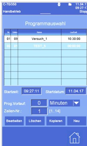
Im Programm kann jede Programmzeile, bzw. das komplette Programm, mit Fehlergrenzen und Toleranzen programmiert werden.
