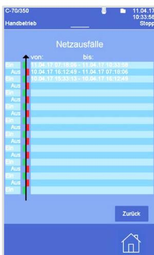
Die Liste der Netzausfälle beginnt und endet mit einer **Ein**-Zeile, da das Gerät in Betrieb sein muss, um die Netzausfälle anzuzeigen. Eine **Aus**-Zeile wird erstellt, sobald ein Netzausfall eingetreten ist. In dieser Zeile wird sichtbar wann der Netzausfall stattgefunden hat.
