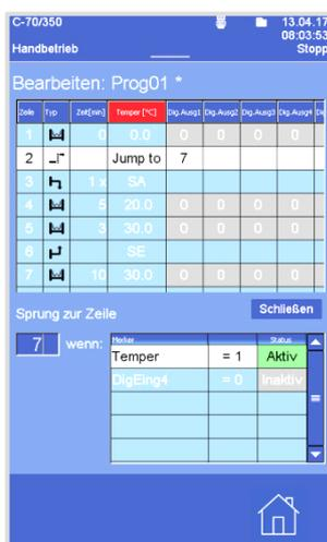
Bei diesem Programmbeispiel wird im Programm von der 2. Programmzeile in die 7. Programmzeile gesprungen, wenn der Merker **Temper =1 (aktiv)** ist.
