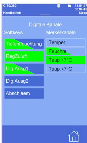
**Softkeys:** Softkeys sind digital Kanäle die aktiviert bzw. deaktiviert werden können. Um einen Softkey zu aktivieren muss er angetippt werden. Sobald der Softkey aktiv ist, wird er grün angezeigt.
