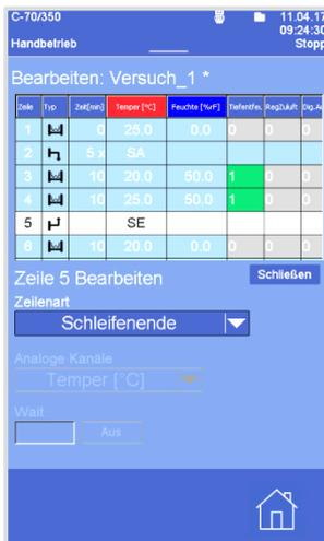
In diesem Programmbeispiel wurde eine Schleife programmiert, bei der das Programmstück (Programmzeile 3 und 4) 5x durch läuft.
