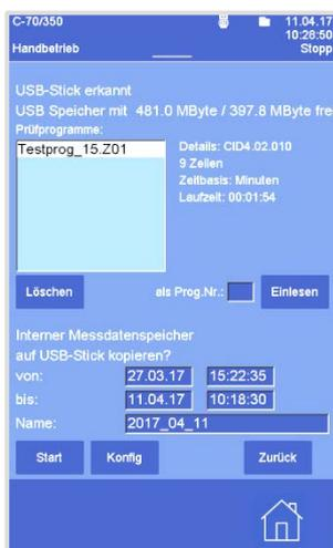
Prüfprogramme die extern erstellt wurden, z. B. am CID-Programm, können mithilfe des USB-Anschlusses in den internen Speicher des Bedienteils eingelesen werden.
