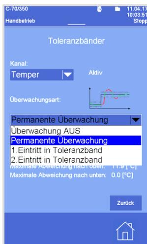
Folgende Einstellungen stehen bei der Toleranzband Überwachung zur Verfügung:
