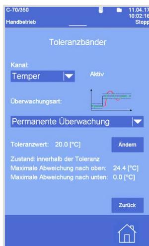
Abhängig davon, welche Überwachungsart bzw. welcher Toleranzwert ausgewählt wurde, werden hier die aktuellen Abweichungen angezeigt.
