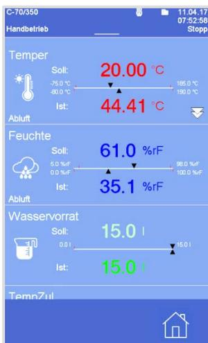
Für jeden analogen Kanal wird eine Skala mit Wertebereich angezeigt.
