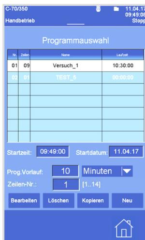
Sobald das Programm startet, wird an eine Stelle im Programm gesprungen. Die Zeit die am Programmanfang übersprungen werden soll, wird im Programmvorlauf vorgegeben.
