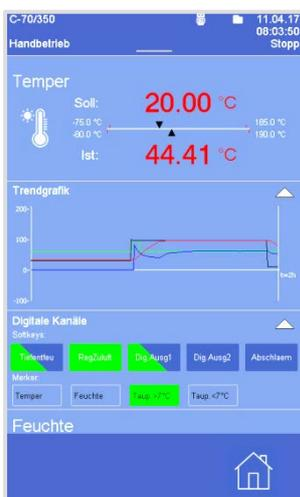
Die digitalen Kanäle werden eingeblendet, sobald der obere, weiße Pfeil angetippt wird.
